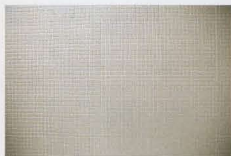
↑ Při otevřené cloně a ohnisku 24 mm dochází k výrazné vinětaci a soudkovému zkreslení.
